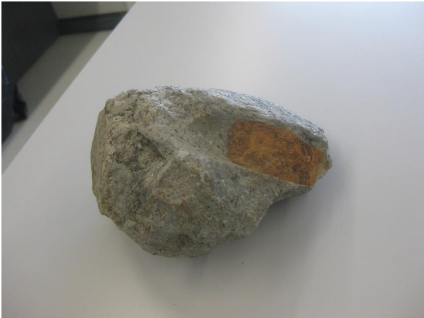
Figura 4- Orifício cilíndrico contendo terracota (mistura de óxido de ferro, cinza e resinas) em peça recolhida no lugar do Posto Santo.
